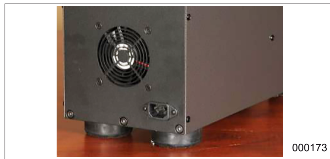
Fig. 13 Exhaust Exit Fan
