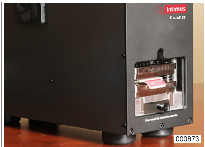
Abb. 9 Zerstörung eines SSD-Laufwerks
