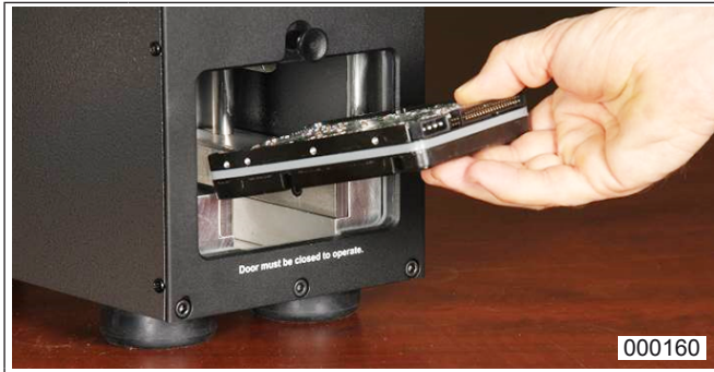
Abb. 4 Einlegen der Festplatte
