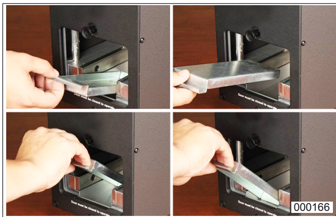
fig. 11 Consejo: Use la bandeja recolectora para la limpieza
