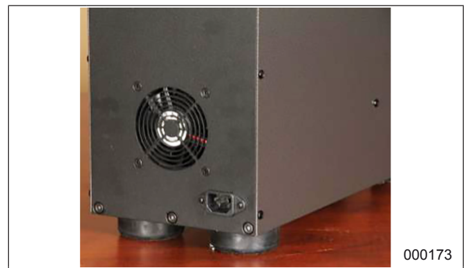
Abb. 13 Luftaustritt an der Rückseite
