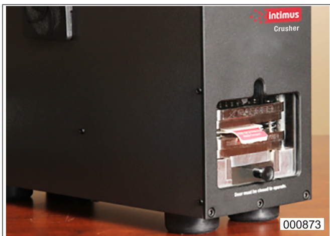
fig. 9 Destruction d'un disque dur SSD
