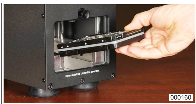
fig. 4 Inserción del disco duro
